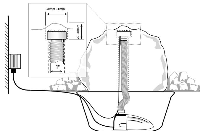
При монтаже светильника Quellstar 900 LED необходимо учитывать следующее:
